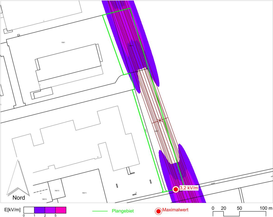
Abbildung 5. Horizontalschnitt des Effektivwerts der elektrischen Feldstärke in 8 m über GOK, inklusive eingezeichnetem Maximalwert.
