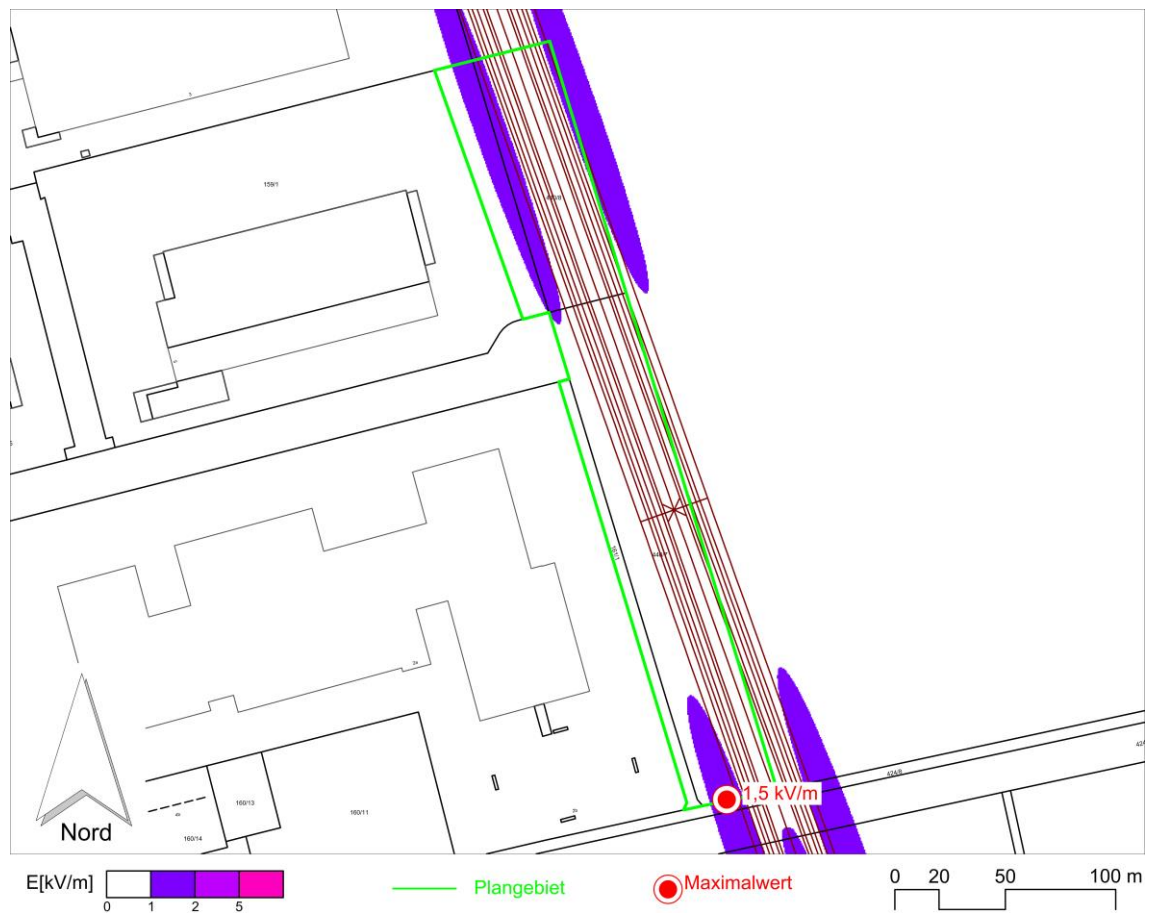
Abbildung 3. Horizontalschnitt des Effektivwerts der elektrischen Feldstärke in 2 m über GOK, inklusive eingezeichnetem Maximalwert.
