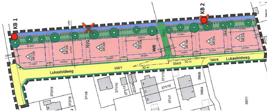
Abbildung 2: Positionen der Kleinrammbohrungen
