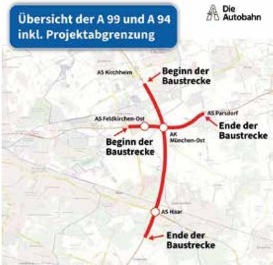
Untersuchungen haben ergeben, dass das Autobahnkreuz München Ost nicht mehr leistungsfähig genug ist. Insbesondere aus den Übereckbeziehungen ergeben sich immer wieder Engpässe, die zu hohen Reisezeitverlusten und Stauungen führen. Das Autobahnkreuz wird daher von einem Vollkleblatt zu einer „abgewandelten“ Windmühle umgebaut (siehe Grafik). Diese neue Form soll für einen fließenden Verkehr insbesondere der stark ausgeprägten Verkehrsströme von Nord nach Ost und von Ost nach Süd sorgen.
