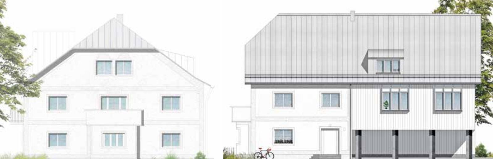
Zwei texturierte Ansichten zum Alten Rathaus in Parsdorf mit der Ostfassade – die Altbaufassade saniert, mit vergrößerten Fensteröffnungen und Herstellung der ursprünglichen abgewalmten Dachform, sowie die Nordfassade, die den Anschluss zwischen Bestand und Neubau zeigt. Grafiken: Fink+Jocher/K.Lorenz
