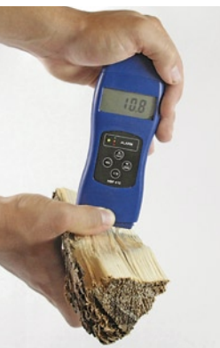
Messung des Wassergehaltes mit einem Schnellbestimmungsgerät
